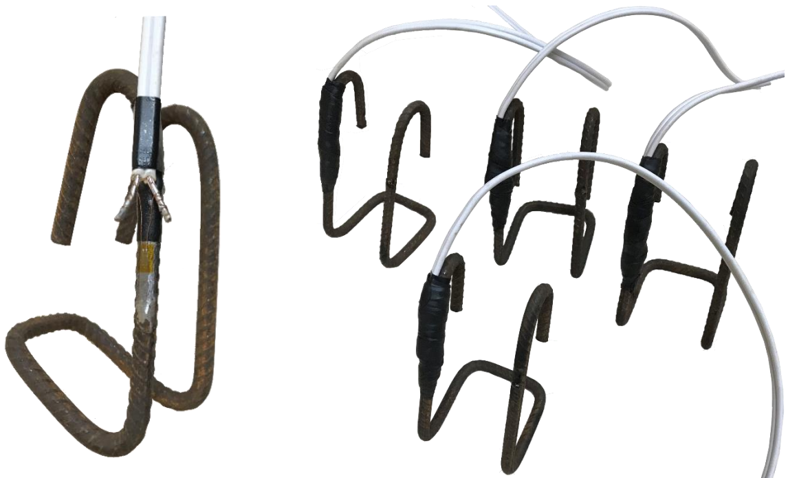
Figura 3.23 – Extensômetro instalado nas armaduras de cisalhamento.
