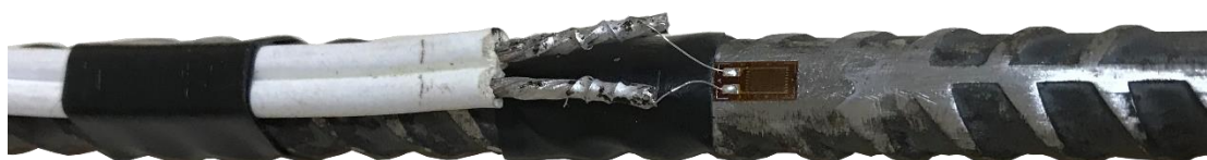
Figura 3.20 – Extensômetro instalado (barra 10 mm).
