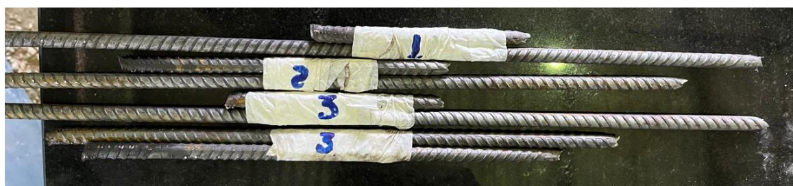
Figura 4.9 – Barras rompidas após o ensaio.
