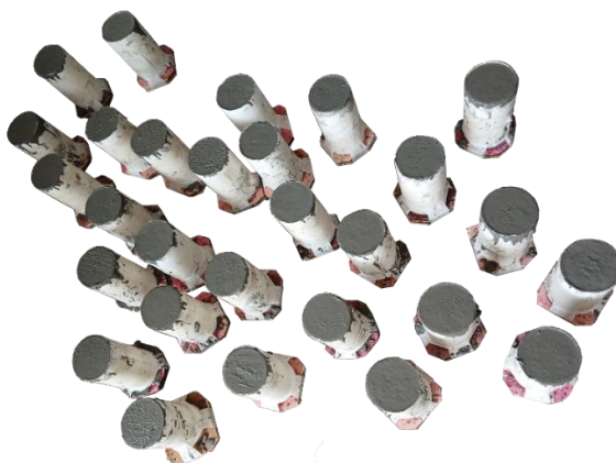
Figura 3.28 – Moldagem dos corpos de prova.
