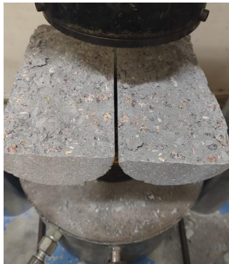
Figura 4.6 – Ensaio de tração por compressão diametral.
