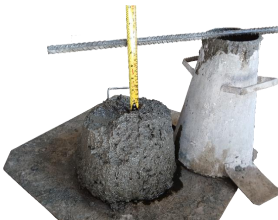
Figura 3.27 – Abatimento obtido no slump test .
