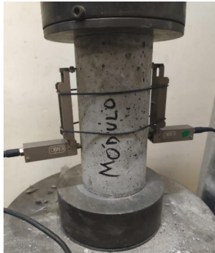
Figura 4.4 – Ensaio de módulo de elasticidade.
