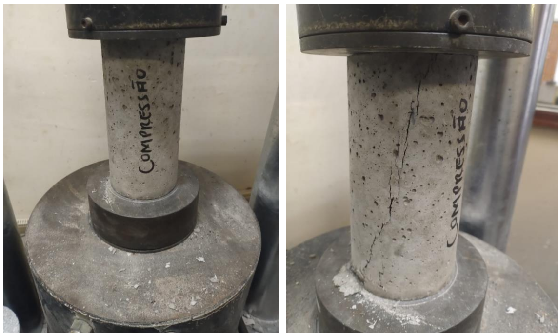
Figura 4.2 – Ensaio de resistência à compressão uniaxial aos 28 dias.
